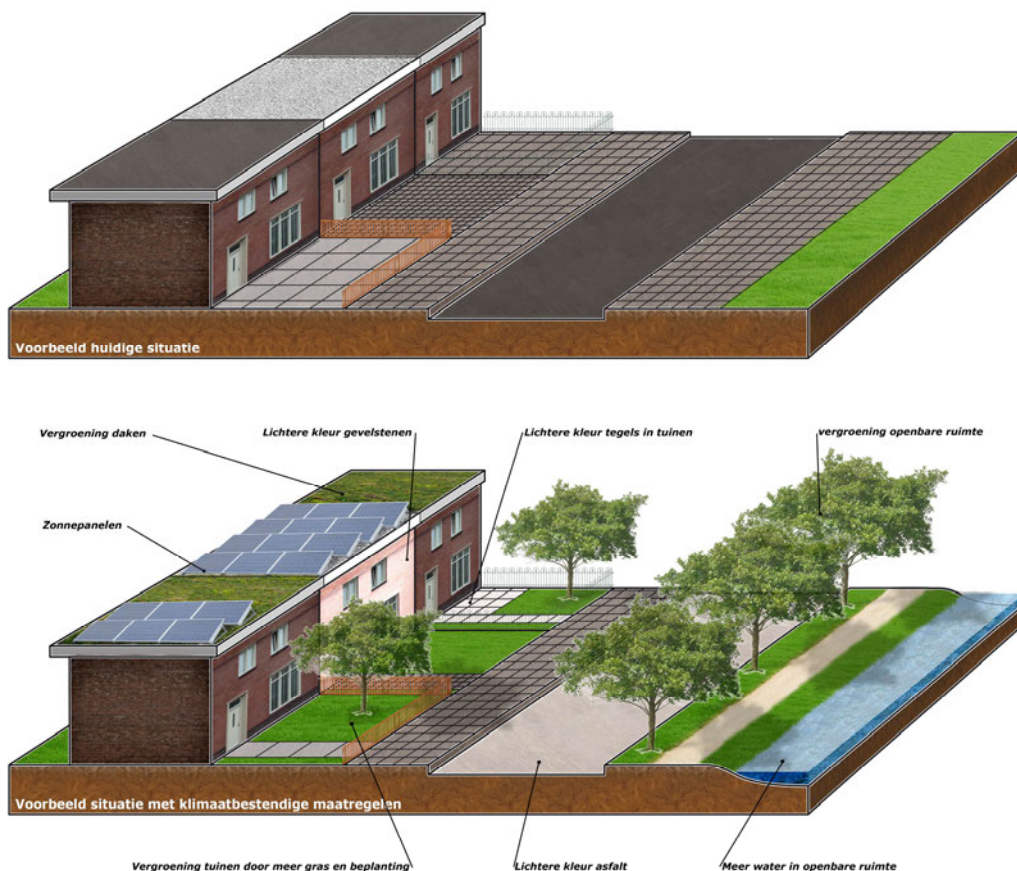
Figuur 1 In het bebouwde gebied zijn allerlei maatregelen mogelijk minder kwetsbaar te worden voor klimaatverandering. Boven: huidige situatie; onder: toekomstige situatie. Beeld: Bosch Slabbers.
